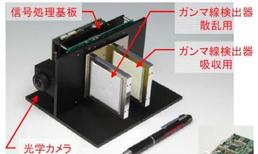
当研究室で開発したガンマ線”3D”可視化技術。右は、現在開発中の「リアルタイム」ガンマ線カメラのプロトタイプ
